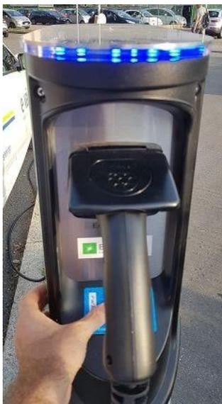
**22.** Appoggiare la **tessera blu** sul sensore della **colonnina**. Il led nella parte alta della colonnina diventa di colore **"VERDE"** lampeggiante. Successivamente collegare il cavo alla presa selezionata. Il led diventa di colore **"BLU"** fisso ad indicare la corretta messa in carica del veicolo.
