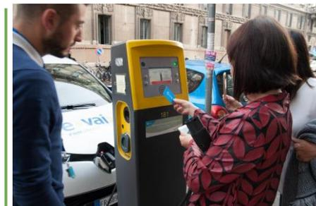
**13.** Appoggiare la **tessera blu** sul sensore della **colonnina** per permettere lo sblocco del cavo
