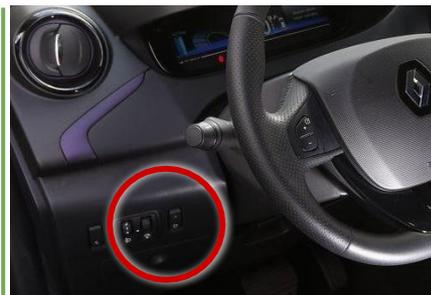
**20.** Per **collegare la vettura alla colonnina di ricarica** premere il **tasto** a sinistra del volante ed aprire lo sportellino di ricarica posto nella parte anteriore del veicolo
