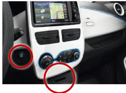
**16.** Per l'accensione del veicolo inserire la **chiave** nell'apposita fessura (solo per Zoe 22 e 40 Kw) e premere il **freno** con il cambio in **posizione P**, successivamente premere il tasto **START/STOP**
