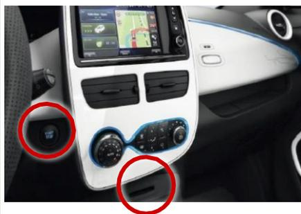
**18.** Per lo spegnimento del veicolo parcheggiare l'auto nello stallo Evai di destinazione, premere il **freno** e portare la leva del cambio in **posizione P**. Infine premere il tasto **START/STOP**
